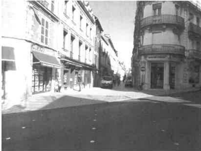
En complément du panneau sens interdit, une sortie retravaillée géométriquement pour limiter le risque de remontée en contresens : la continuité de la bordure et de la chaussée principale n'invite pas l'utilisateur motorisé à s'aventurer dans l'aire piétonne (Pau)
